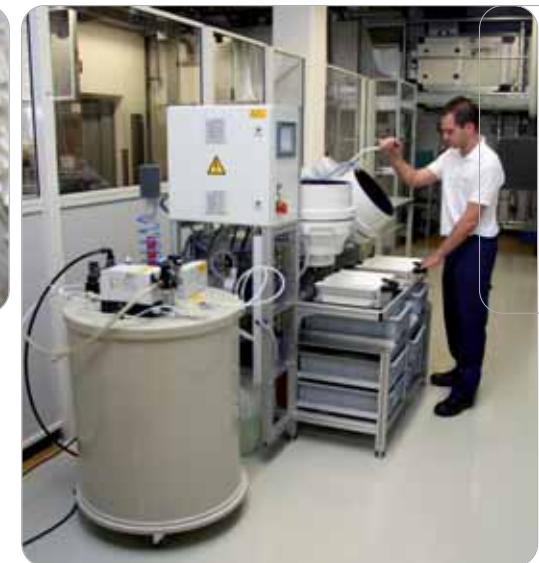
Oberflächenglättung: Gleitschleifen mittels ver- schiedener Schleifkörper
