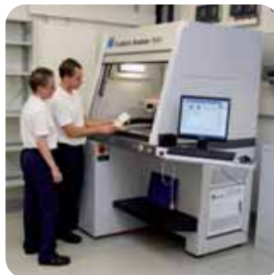
Laserbeschriftung von Instrumenten und Implantaten
