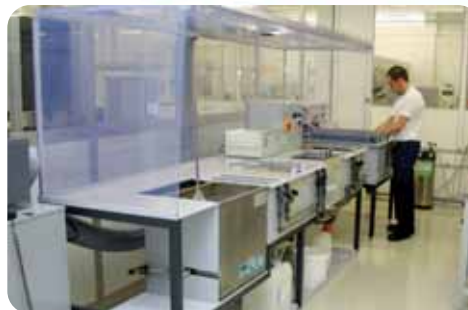
Oberflächenbeschichtung: Anodisieren von Implantatschrauben
